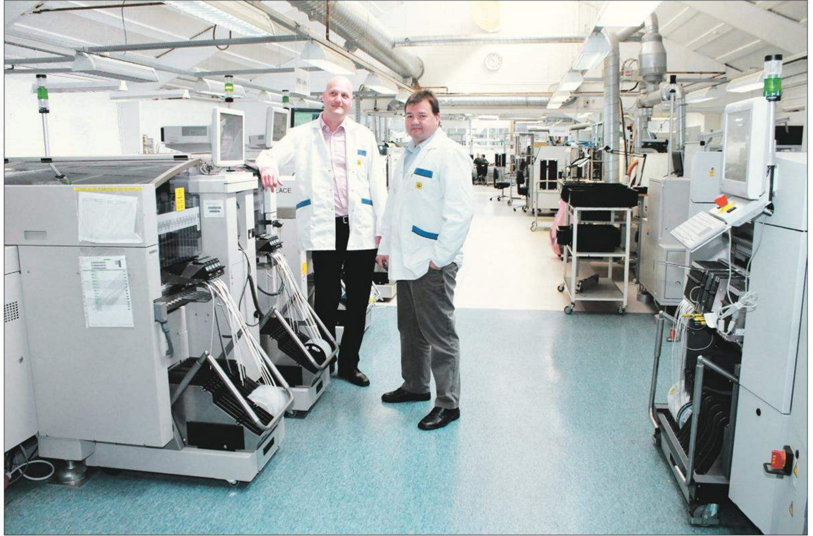
Thomas Hansen (tv) og Stefan Danchell ved en af de ASM Siplace-linjer, som er i stand til at montere komponenter helt ned til 01005-formatet.
