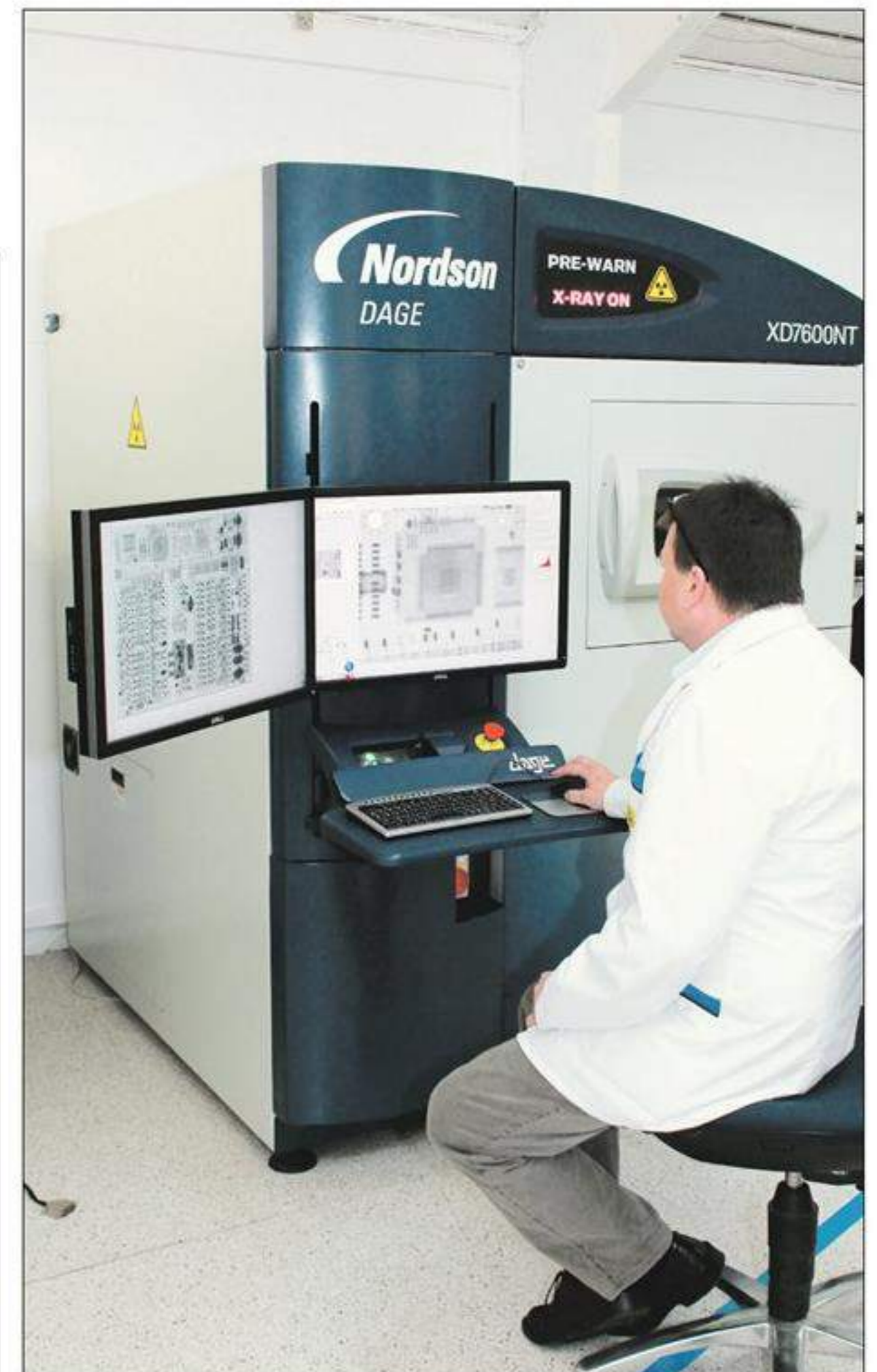
Stefan Danchell ved det røntgenudstyr, der med en fantastisk kontrast og opløsning gør det muligt ikke bare at identificere fejl, men i mange tilfælde også at kunne forklare kunden, hvordan fejlen er opstået.
