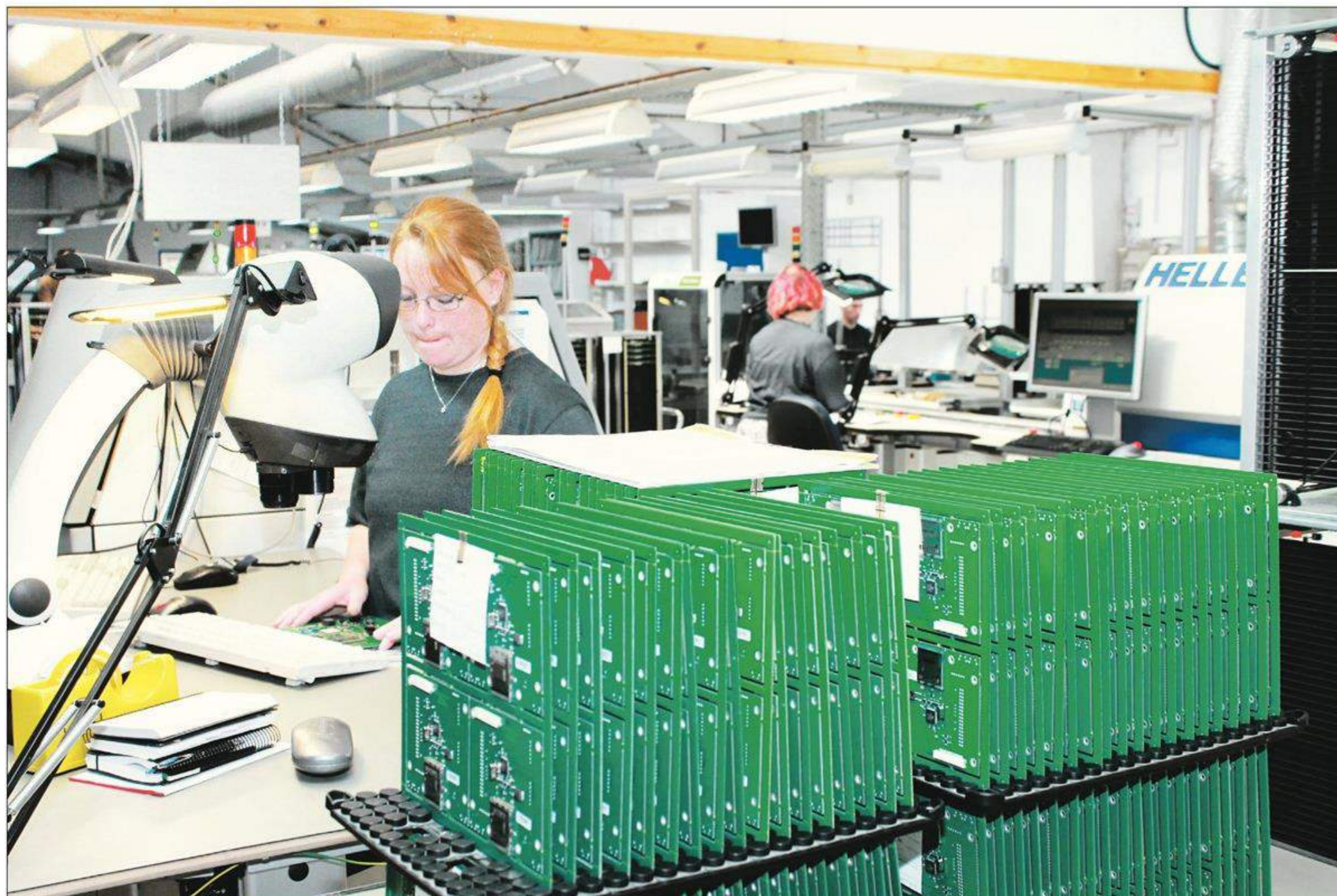
Kvalitet er afgørende, og alle Danchell-montricer er IPC-610 certificerede. Her inspicerer Susan Jørgensen en serie af bestykkede print.
