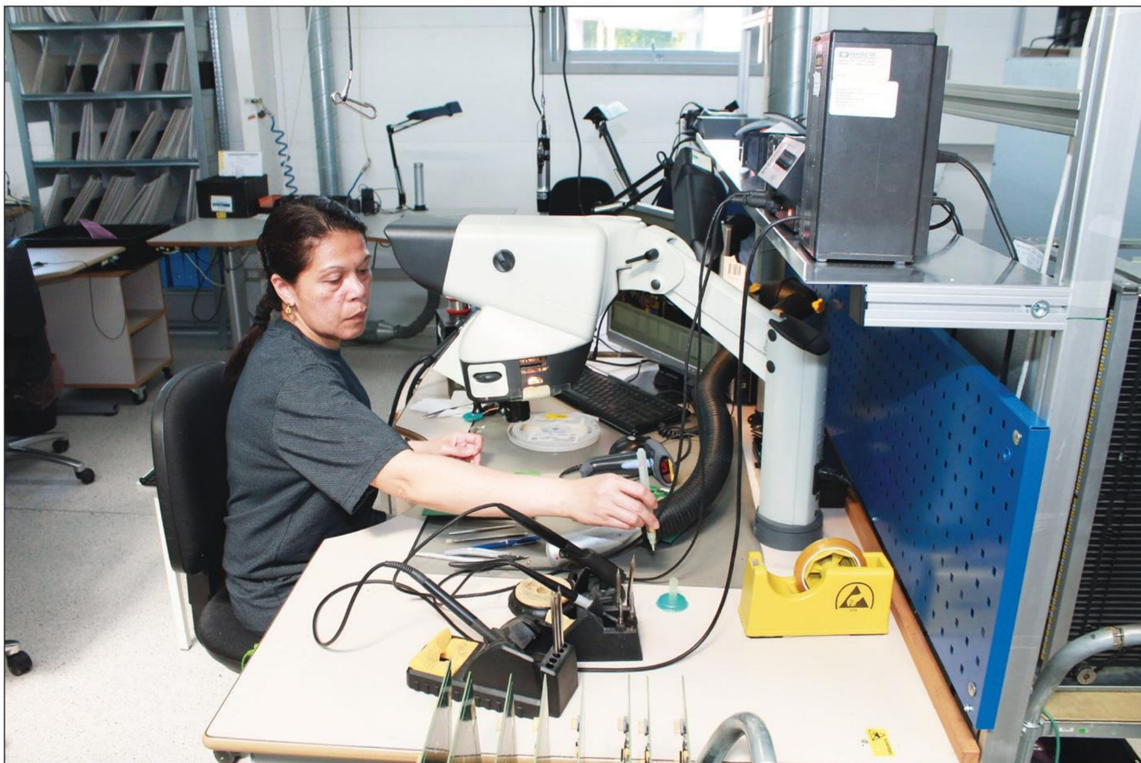
Sammen med DI har Danchell udført et Lean-projekt, som skal forbedre konkurrenceevnen. Nogle få ændringer har gjort underværker. Gemma Holst arbejder nu i en U-formet montagecelle, hvad der fungerer meget bedre end den tidligere opstilling af arbejdspladserne, og hun er som alle sine kolleger IPC-610 certificeret, så lodningerne er i orden.
