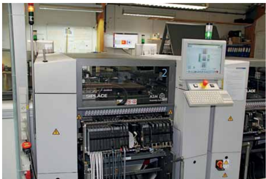
ASM SIPLACE SX er en af Danchells nyeste SMD bestykningslinjer. SIPLACE SX sikrer, at produktionen af mindre serier og prototyper er mere effektive.
